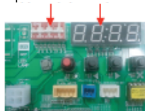
Плата наружного блока
